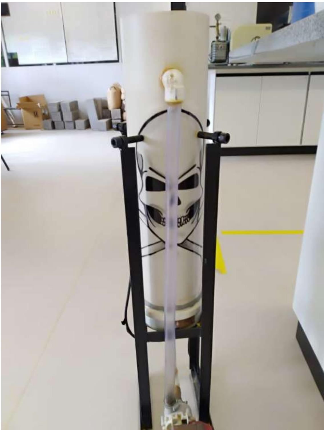
A Figura 4 mostra a vista posterior do dispositivo produzido, testado e utilizado na lavagem dos polímeros sulfonados no Laboratório 209 no Centro de Tecnologias Limpas da Feevale.
